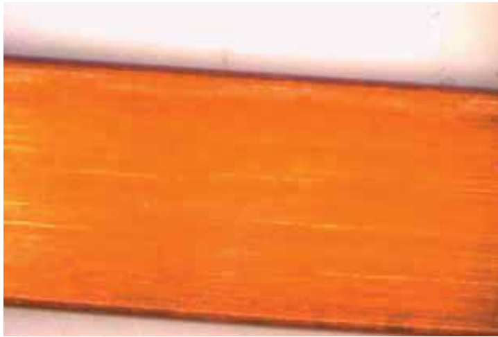
Fig. b: Cobre y tiras de papel después de una prueba con aceite corrosivo
