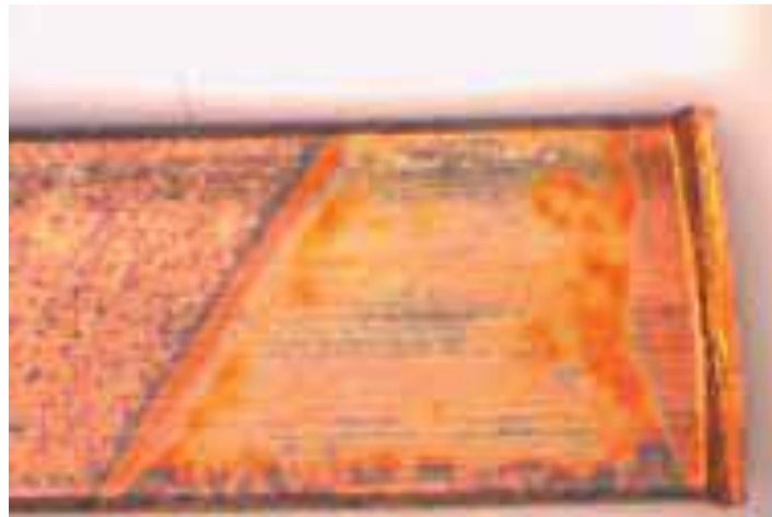
Fig. b: Cobre y tiras de papel después de una prueba con aceite corrosivo
