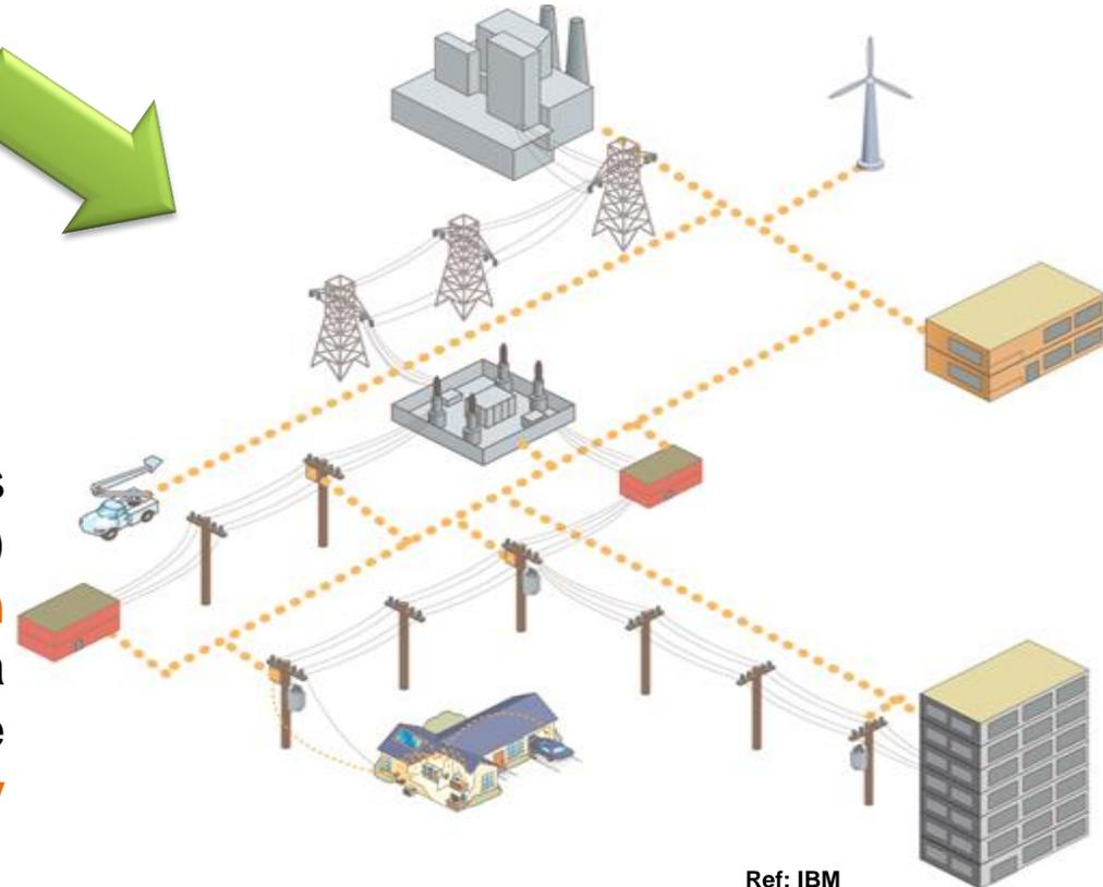
(1) Red eléctrica transformada (en los niveles de transmisión y distribución) que utiliza sistemas de **comunicación bidireccionales**. (2) Sobrenombre para una amplia paleta de aplicaciones que potencian la capacidad de **monitoreo y control** de una red eléctrica.
